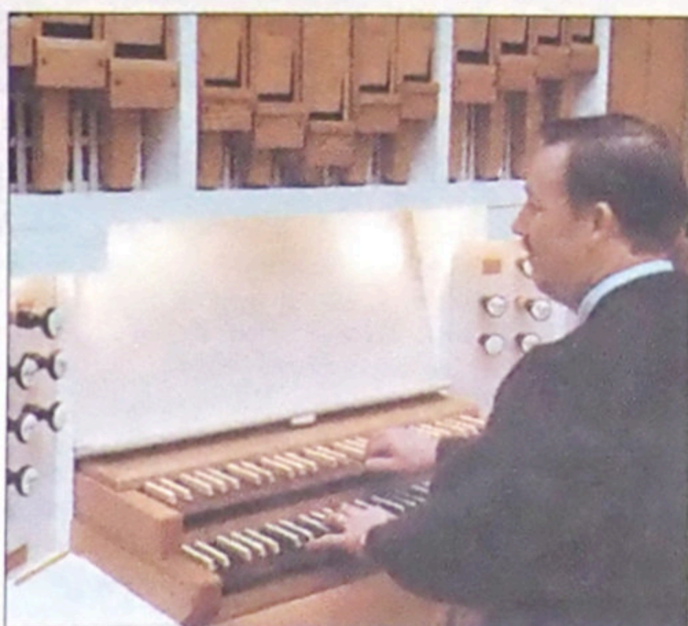
Juhani Martikainen on rakentanut Lapväärtin seurakuntataloon "kierätyksurut", jossa vain sormio on hankittu uutena.
